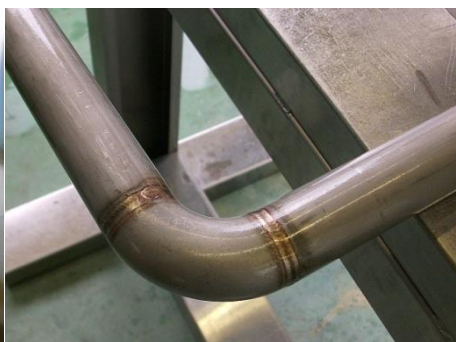
サンダー仕上げの必要ない溶接技術
