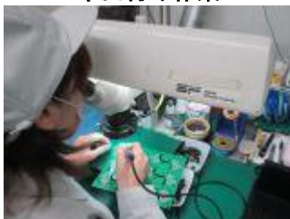
半田付け作業
