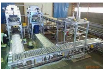
震災復旧溶融減容化施設 ドラム缶自動充填装置
