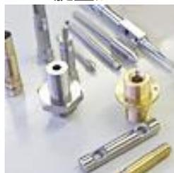
シャフトなどの小径ものを中心に、旋盤のみでなく研磨まで一貫対応。研磨ローレット加工まで行っています。
