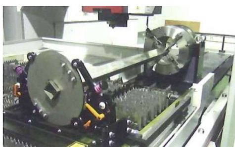
NC ターンテーブル大口径レーザー加工機 最大口径150mmの角パイプの貫通把持が可能。 パイプ受けの設置により長尺物の加工も可能。
