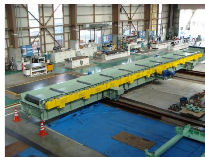
トラバーサ W3.5m x L19.6m (積載重量17t)
