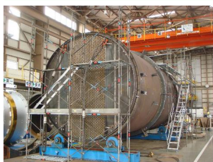
熱交換器 Φ4.1m x L7.5m (重量51t)
