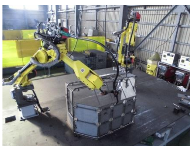
協調型溶接ロボット 2台が1つのワークの相互干渉動作を認識し、高能率で溶接稼働。
