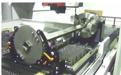
NC ターンテーブル大口径レーザー加工機 最大口径150mmの角パイプの貫通把持が可能。 パイプ受けの設置により長尺物の加工も可能。
