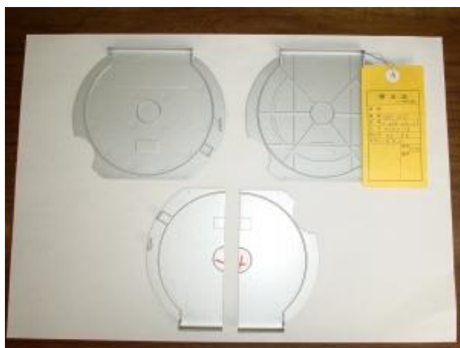
本薄肉アルミダイカストサンプル 直径 126、肉厚 0.6(実際の検定合格品)
