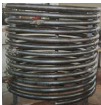
パイプ曲げ加工
