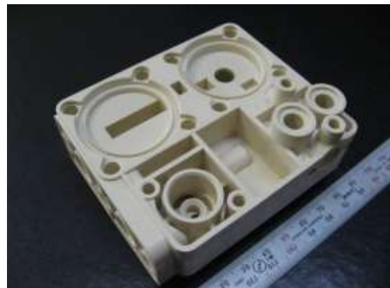
医療器具向け射出成形部品 材質: 樹脂(変性 PPO/PPE)
