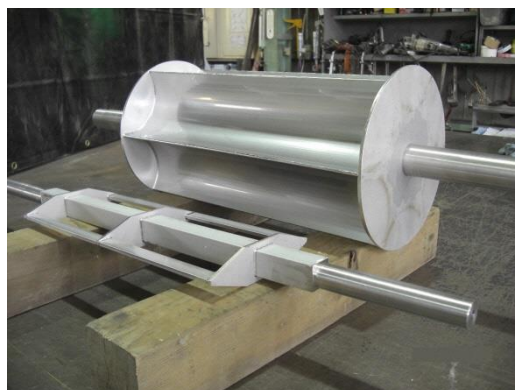
消毒槽攪拌機
