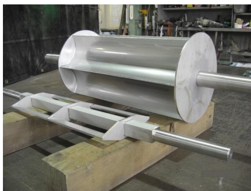
消毒槽攪拌機
