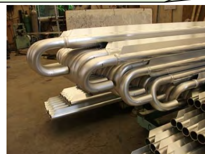
アルミパイプの曲げ加工 (40φ-60R)
