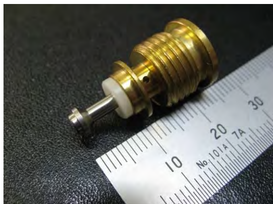
エアーツール向け切削部品 材質：真鍮、ステンレス、樹脂(POM) 部品の圧入も行います。 (圧入力・抜去力管理含む)
