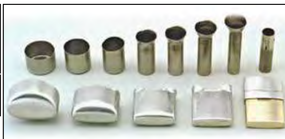
絞り型見本 上段 トランスファ(ステンレス材) 下段 トランスファ(アルミ材)
