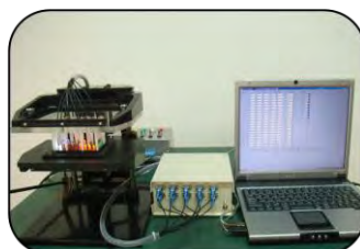
【LED 検査アライザー】 発光デバイス(LED)の色あい 輝度の検査が可能 標準、高輝度と様々な LED 検査に対応
