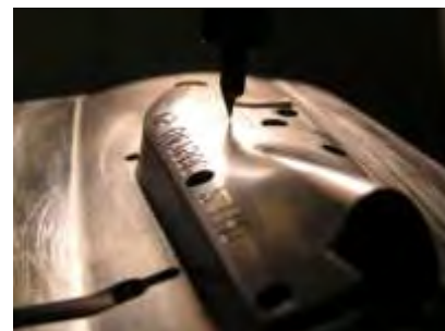
彫刻機を用いて自由曲面に文字彫刻を施す
