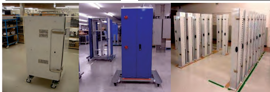
&lt;屋外筐体：厚膜粉体/UV塗装・防水試験対応&gt;
