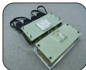
【低高温環境テスト治具】 試験動作環境温度-40℃～ +120℃に対応。セミオート、フル オートなど各自動機器に対応
