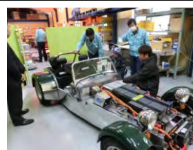
日本初チャデモ急速充電式コンバートEV 製作 日本 EV クラブとの日本一周急速充電の旅企画
