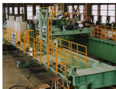
35t×18.8m 旋回吊ビーム付天井クレーン
