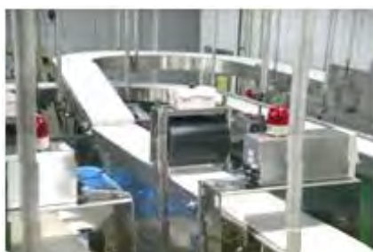
ベルトコンベア(プラスチックベルト) (ブロイラー工場)
