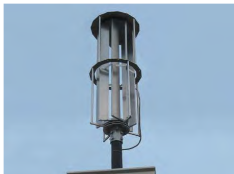
小型風力発電機 (OEM 生産製品:設計含む)
