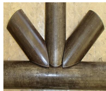
パイプコースターによる枝管
